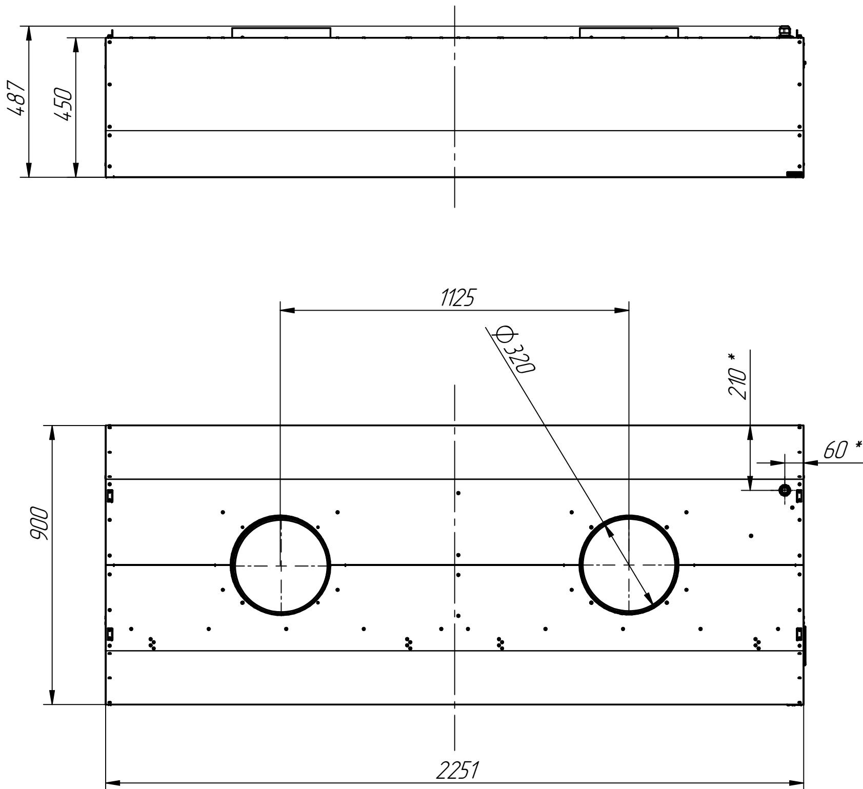
Зонт вентиляционный, используется для очистки воздуха от аэрозолей жира, масла, водяного пара и устанавливаются в системе вытяжной вентиляции на объектах общественного питания. Пары масла, жира, проходя через лабиринтные фильтры, оседают на жироуловителях и стекают в жироотделитель. Зонт вентиляционный размещают над любым тепловыделяющим кухонным оборудованием (плитой, жарочным шкафом, фритюрницей и т. п.). Комплектуется вентиляторами и лампами подсветки.
